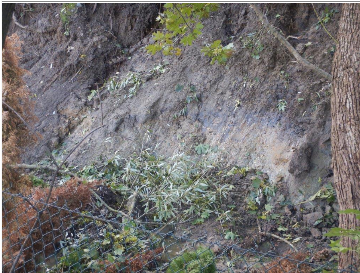
Powierzchnia poślizgu (złustrowania) u podnóża skarpy głównej osuwiska
